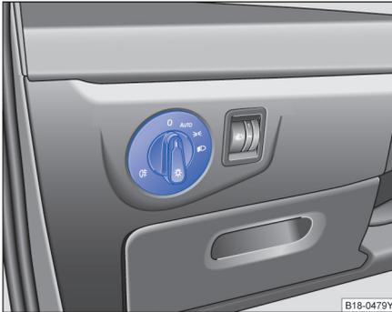
图 67 仪表板局部视图：灯光开关
