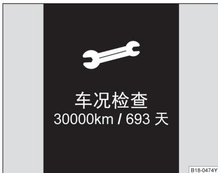
图 14 在组合仪表的显示屏中：某个保养项目到期时的显示示例（示意图）。
