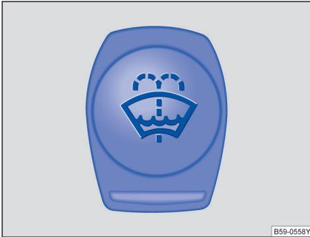
图 133 发动机舱内：车窗清洗液容器盖。
