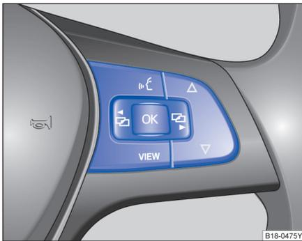
图 15 多功能方向盘右侧：用于操作信息显示器中菜单的按钮。
