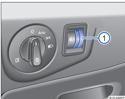
图 68 在方向盘旁边：大灯照明距离调节的调节器
