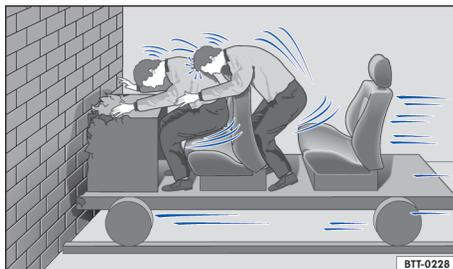
图 22 载有未系安全带的驾乘人员的汽车撞到墙上
