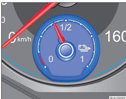
图 109 在组合仪表盘上：高压蓄电池的电量表和备用电量区域。
