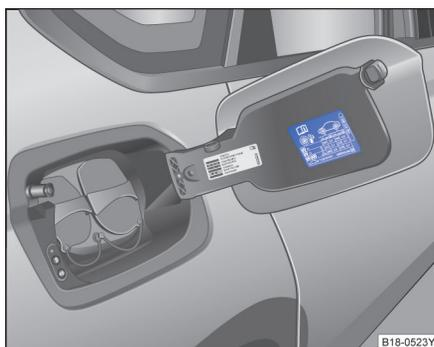
图 140 高压电池充电盖板内侧上：胎压标签
