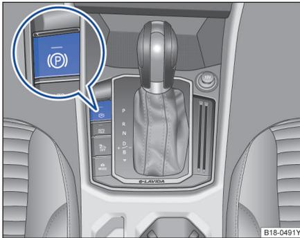
图 95 电子驻车制动器按钮。
